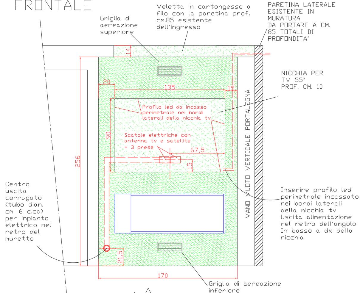
Centro uscita corrugato (tubo diam. cm. 6 c.ca) per impianto elettrico nel retro del muretto
